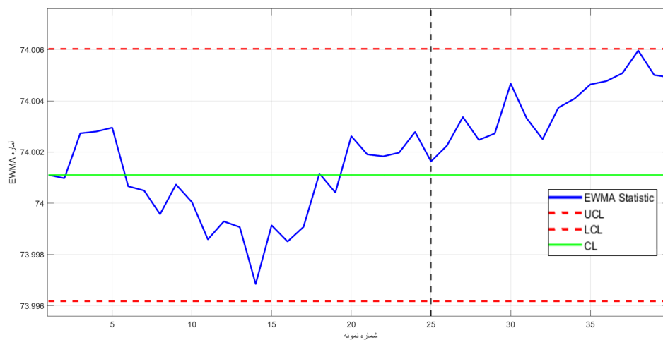
شکل ۵: نمودار کنترل EWMA با \lambda = 0.25 و H = 2.912 .
